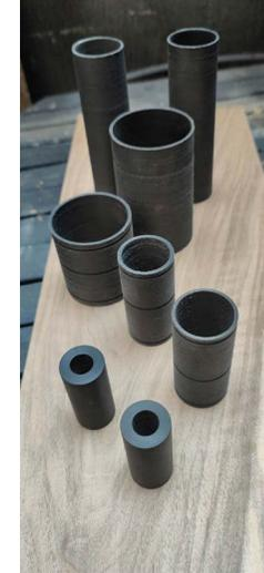
Nouvelles douilles et embouchures en fibre de lin et de carbone, et imprimante 3D
